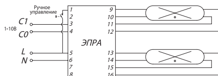
Схема включения двухламповая с ЭПРА, с управлением
