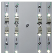
Равномерное распределение светодиодов на собранном модуле
