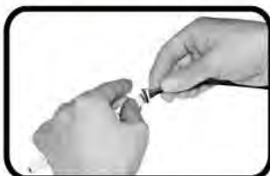
Шаг 2. Вставить ленту в разъем соединителя.
