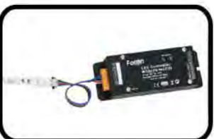
Шаг 4. Подключить соединитель к драйверу при помощи клемм или специальных разъемов в зависимости от вида соединителя
