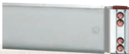
РАСПРЕДЕЛИТЕЛЬНЫЕ ШИНОПРОВОДЫ СЕРИИ SCP ОТ 630 А ДО 6300 А ТРЕХФАЗНЫЕ: ■ С 4 ПРОВОДНИКАМИ (3L+N+PE, 3L+PEN, 3L+FE+PE) ■ С 5 ПРОВОДНИКАМИ (3L+N+FE+PE) ■ ИЛИ ДВОЙНОЙ НЕЙТРАЛЬЮ (3L+2N+PE)
