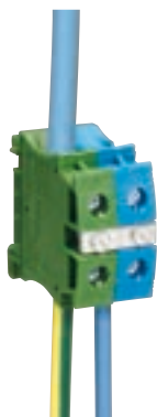
Преобразование схемы TN-C в TN-S Разделение PEN-проводника сечением 10 мм 2 0 371 98 + 0 371 04 + 0 375 42
