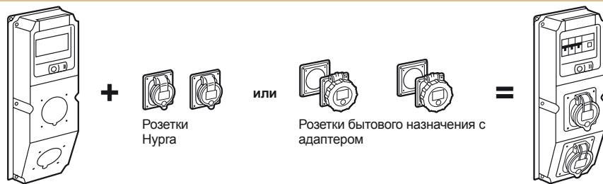
Щиток с отверстиями
