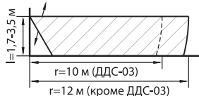
ДДС Зона обнаружения по вертикали (вид сбоку)
